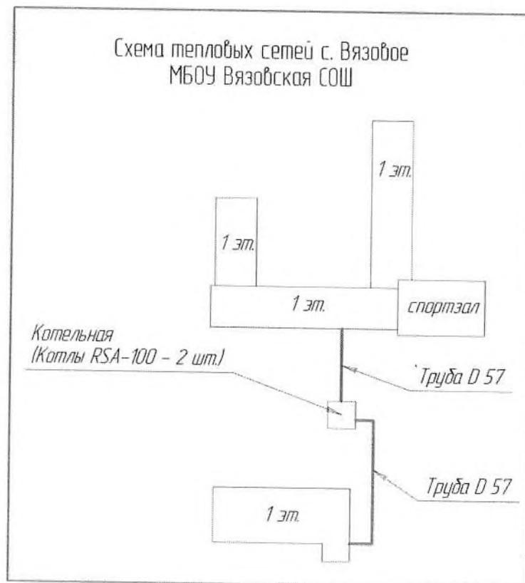
Рисунок 4.2 – Схема теплоснабжения МБОУ Вязовская СОШ
